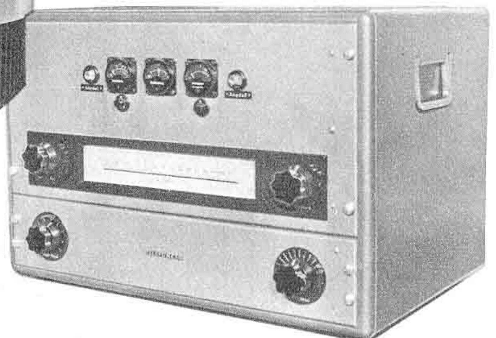
Rechts: Telefunken-19-Röhren-UKW-Ball- und Monitor-Empfänger EB/VK/3/1 für 87 ... 100 MHz
