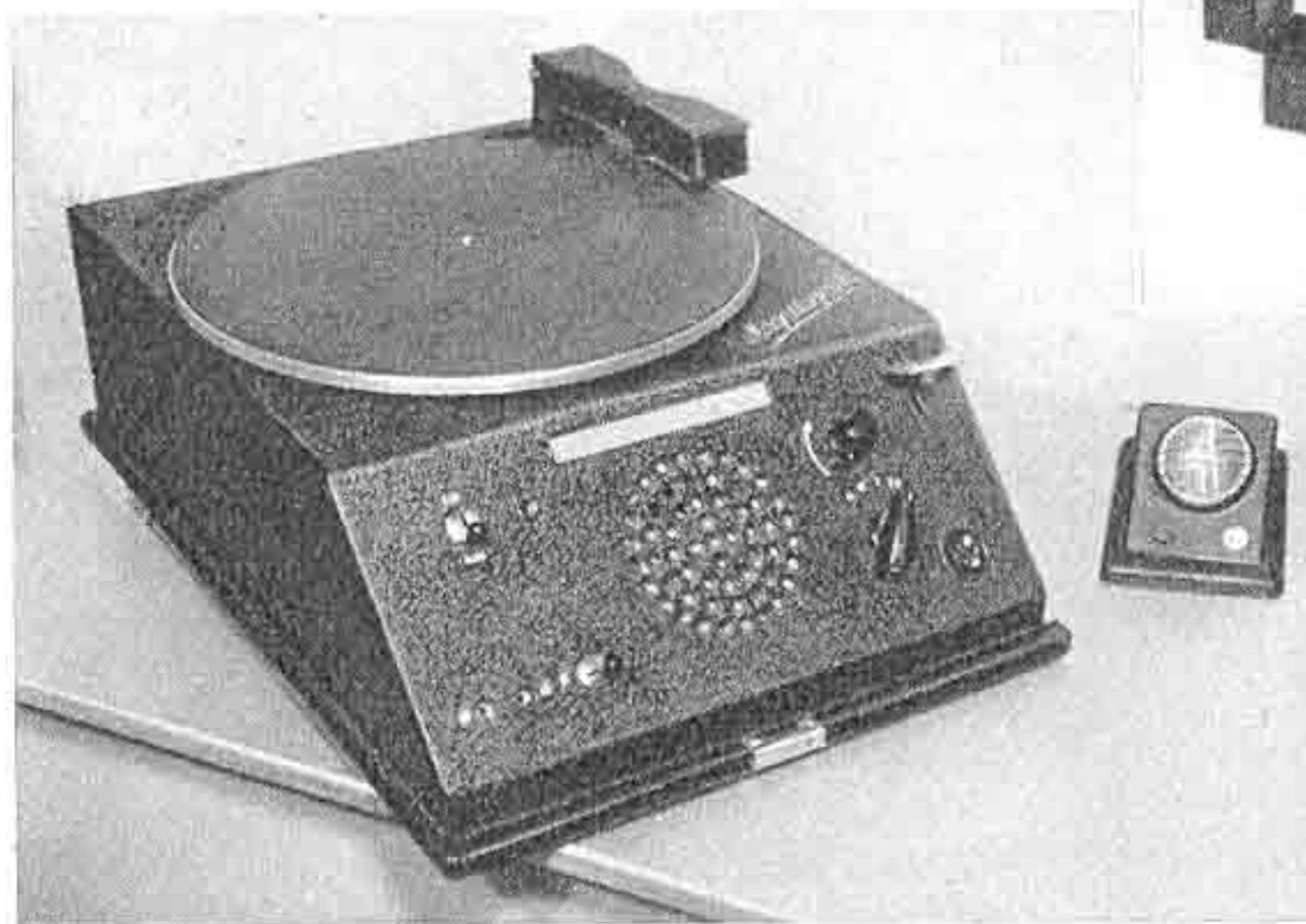
Magnetograph der Metallophon-Tonograph-Apparatebau Franz von Trümbach, Berlin
